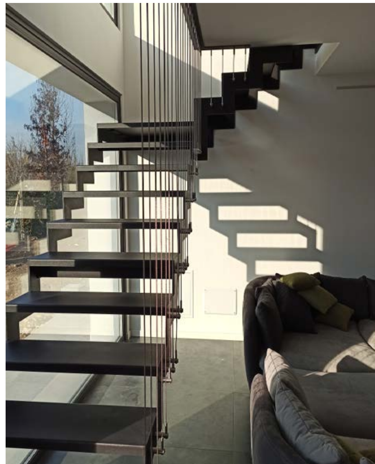
LASER2 + ROD SCALA A GIORNO COMPOSTA DA DOPPIA STRUTTURA SAGOMATA E GRADINO IN LAMIERA PIEGATA IN ACCIAIO VERNICIATO CON PROTEZIONE LATERALE ROD A CAVETTI IN ACCIAIO INOX.
